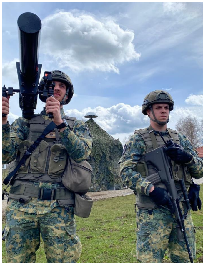
Oben: Ein elektromagnetisches Drohnenabwehr-Gewehr. Links: ELDRO-Detektionsantenne mit Soldaten des JgB8 in Stellung.
